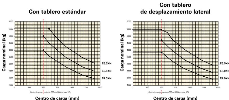
**Centro de carga:** Distancia desde la parte delantera de las horquillas al centro de gravedad de la carga.
