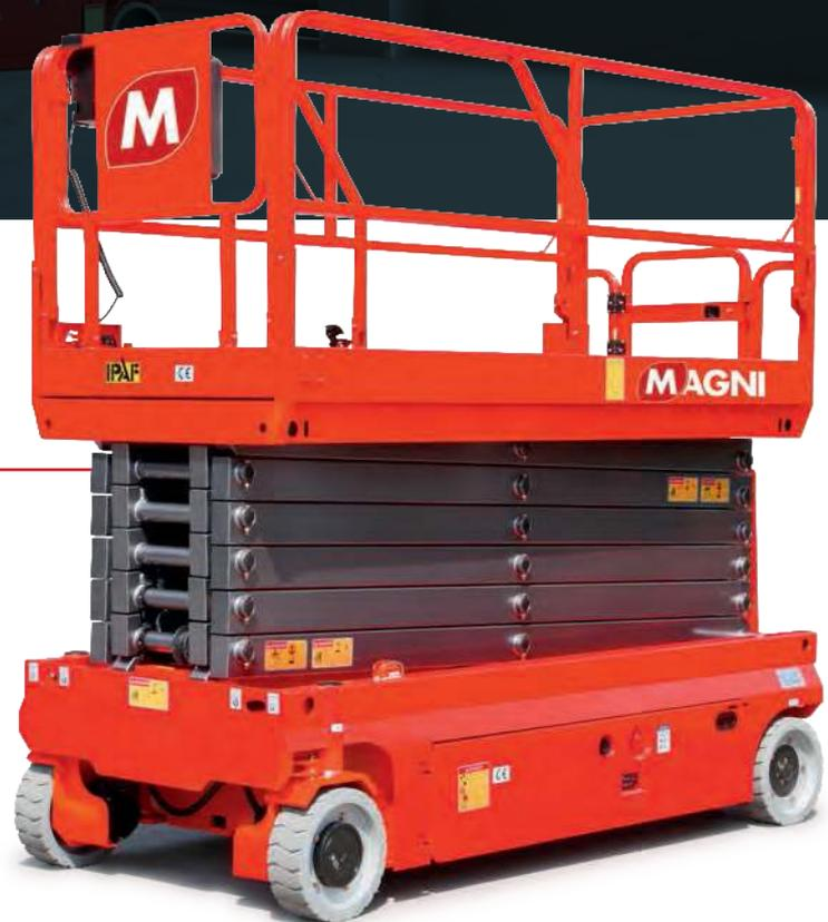
Las plataformas de tijera Magni se accionan mediante un motor eléctrico. Los principales componentes están sujetos al rígido control de calidad y seguridad Magni. Equipamiento robusto con maniobrabilidad y seguridad incomparables. El sistema de elevación de tijera eléctrico permite ahorrar energía, garantizando cero emisiones y un funcionamiento muy silencioso. Con una gama de alturas de trabajo de 5 a 15,7 metros, es el producto ideal para todo ambiente de trabajo, tanto interior como exterior.
